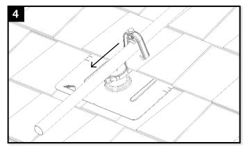
Position Clamp over conduit and snap onto Conduit Cap.
