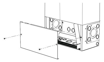
Figure 2-10 Conduit Box installation
