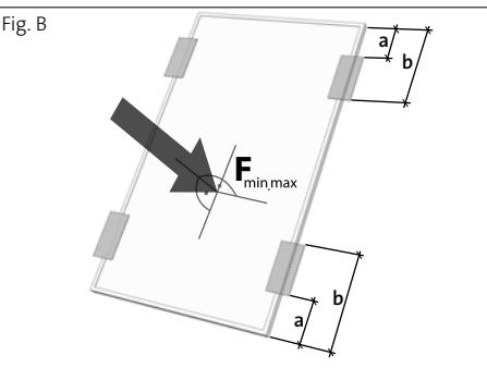
**a** = 239 mm (9.4 in)       $F_{\min} = -3,1 \text{ kN/m}^2$  (- 64 psf)
