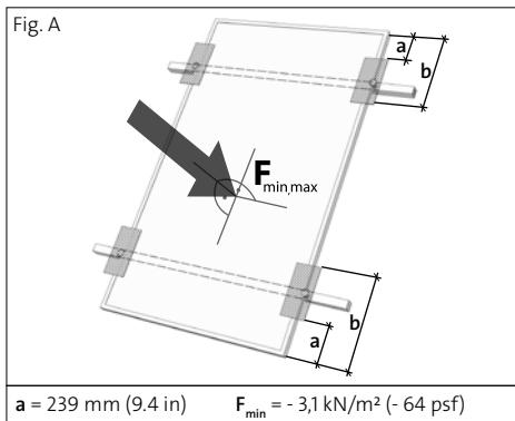
**a** = 239 mm (9.4 in)       $F_{\min} = -3,1 \text{ kN/m}^2$  (- 64 psf)
